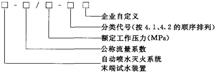
示例 1: ZSPM-80/1.2-S 表示公称流量系数  $K=80$ 、额定工作压力为 1.2 MPa 的手动式末端试水装置。
