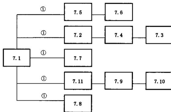
说明:方框中的数字表示试验序号,圆圈中的数字为试验所需试件数。
