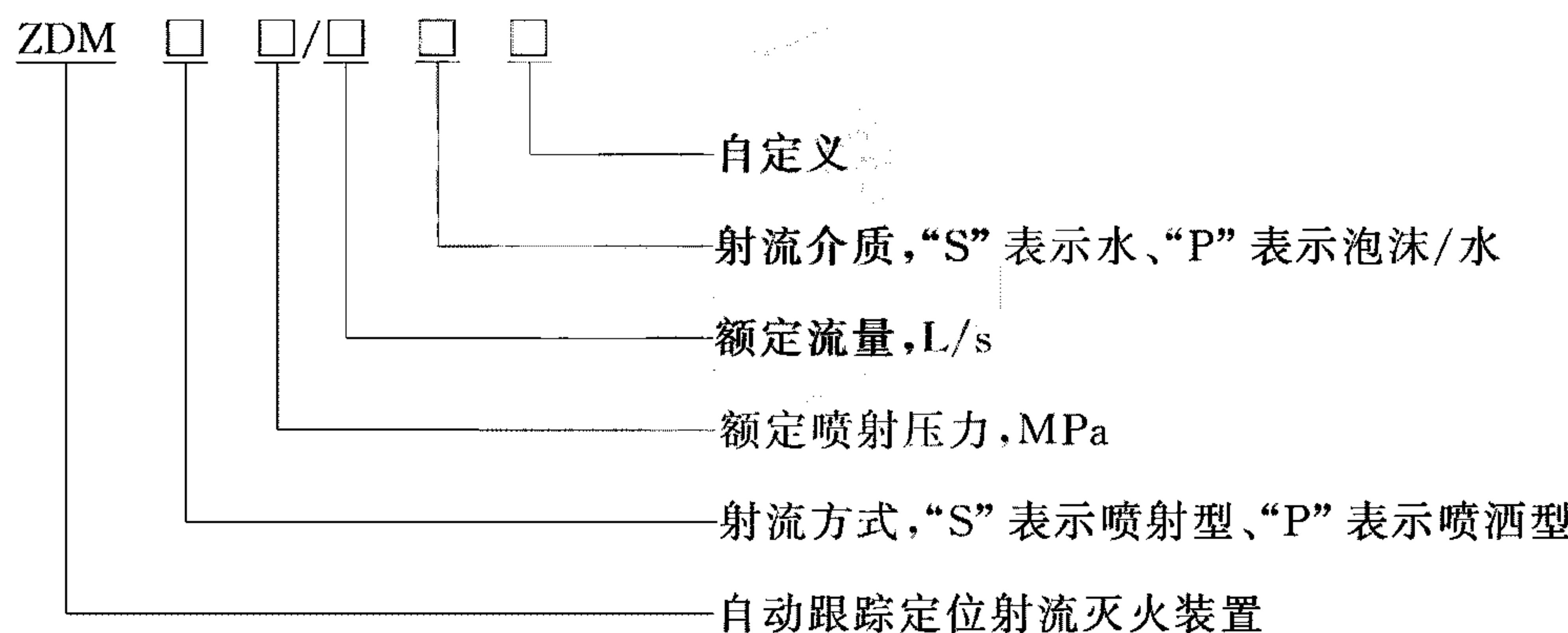
示例 1: 额定喷射压力为 0.25 MPa, 额定流量为 5 L/s, 射流方式为喷洒型, 射流介质为水的自动射流灭火装置其型号为: ZDMP0.25/5S;
